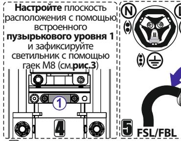
Настройте плоскость расположения с помощью встроенного пузырькового уровня 1 и зафиксируйте светильник с помощью гаек М8 (см.рис.3)
