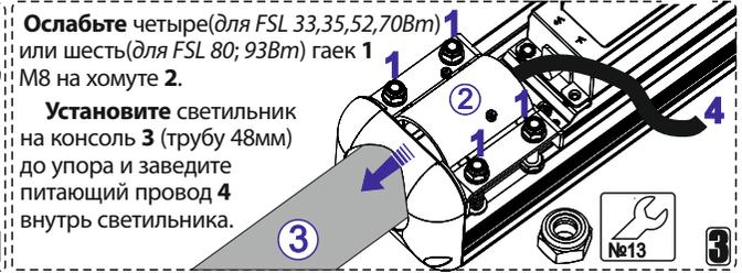
Ослабьте четыре(для FSL 33,35,52,70Bm) или шесть(для FSL 80; 93Bm) гаек 1 М8 на хомуте 2. Установите светильник на консоль 3 (трубу 48мм) до упора и заведите питающий провод 4 внутрь светильника.
