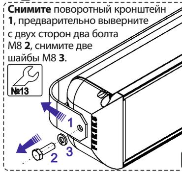
СНИМИТЕ поворотный кронштейн 1, предварительно выверните с двух сторон два болта М8 2, снимите две шайбы М8 3.
