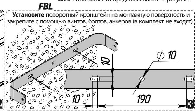
Установите поворотный кронштейн на монтажную поверхность и закрепите с помощью винтов, болтов, анкеров (в комплект не входят).
