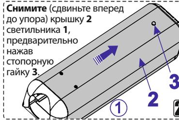
Снимите (сдвиньте вперед до упора) крышку 2 светильника 1, предварительно нажав стопорную гайку 3.
