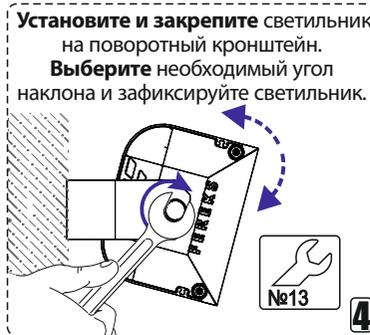
Установите и закрепите светильник на поворотный кронштейн. Выберите необходимый угол наклона и зафиксируйте светильник.
