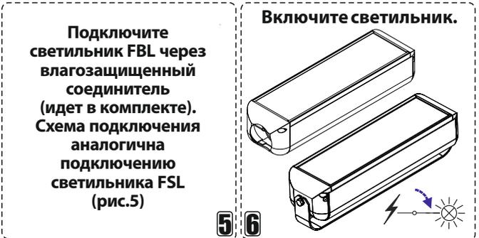
Подключите светильник FBL через влагозащищенный соединитель (идет в комплекте). Схема подключения аналогична подключению светильника FSL (рис.5)
